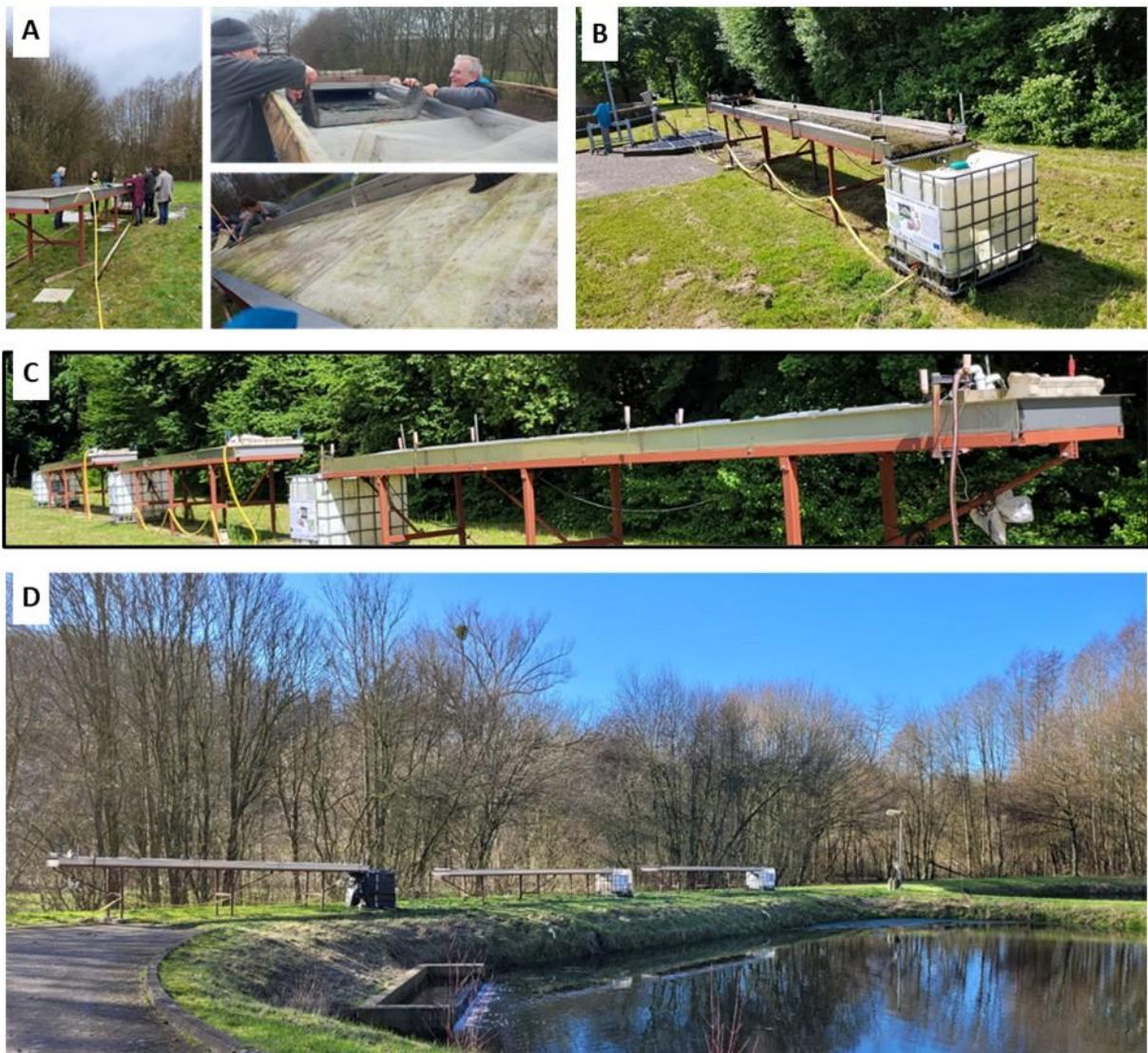
Abbildung 11: Umzug und Platzierung der drei ATS-Systeme an der Kläranlage Lichtenau. A) Aufbau und B-D) Inbetriebnahme ATS-Systeme am Standort der Kläranlage.
